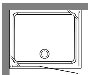
**9143** Cabina doccia SX con porta battente e fisso laterale per piatto doccia 80x96 DX apertura lato 80. Left shower enclosure with door for right shower-tray 80x96 opening on 80 side. Usable opening 65 cm, height 180 cm.
