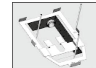
02 - Tracciare dei segni sul pavimento in corrispondenza dei tre fori del telaio.
