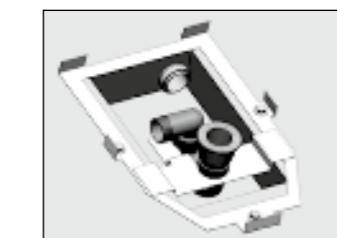
05 - Posizionare il sifone con la piletta sulle due forchette del telaio.
