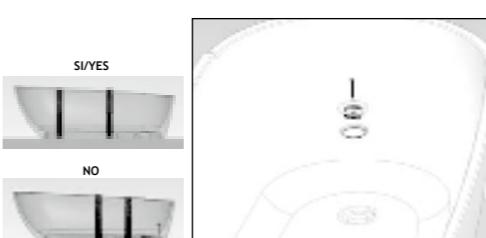
11 - Fissare la ghiera alla piletta mediante l'apposita vite; stringere fino a schiacciare la guarnizione.
