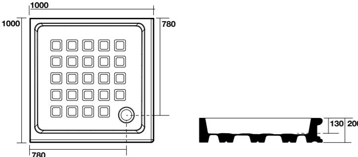
**9148** Cabina doccia DX/SX a due porte battenti e fisso in linea per piatto doccia 100x100 quadro. Apertura utile 36 cm per anta, altezza 180 cm. Reversible shower enclosure with two doors for corner shower-tray 100x100. Usable opening 36 cm, height 180 cm..
