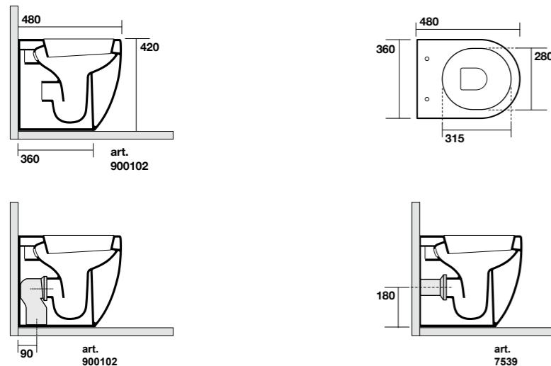
**3115** Vaso sospeso completo di protezione acustica e antiurto e fissaggio WB5N
