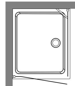
**9144** Cabina doccia DX con porta battente e fisso laterale per piatto doccia 80x96 SX apertura lato 80. Apertura utile 65 cm, altezza 180 cm. Right shower enclosure with door for left shower-tray 80x96 opening on 80 side. Usable opening 65 cm, height 180 cm.
