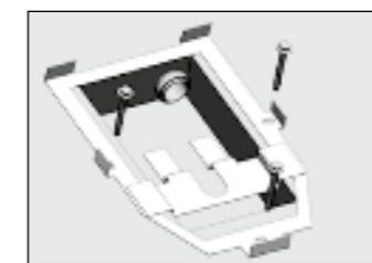
04 - Fissare il telaio al pavimento con i tre fisher in dotazione.
