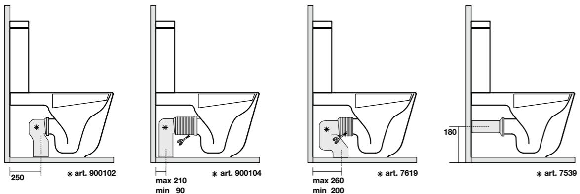
**5125** Bidet sospeso monoforo completo di protezione acustica e antiurto e fissaggio WB9N
