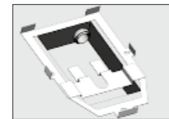
01 - Posizionare il telaio in dotazione sul pavimento allineandolo come in figura allo scasso realizzato precedentemente.
